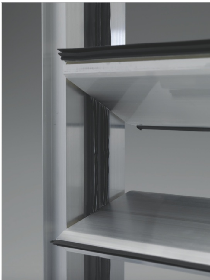
Fig. 3 - Le guarnizioni degli stipiti verticali del telaio della serranda devono essere realizzate in silicone o materiale simile resistente e non conduttivo.
