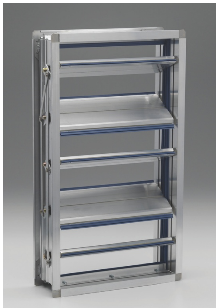
Fig. 1 - Per determinare l'efficienza energetica di una serranda coibentata è assolutamente necessario valutare le prestazioni delle alette a profilo alare, delle guarnizioni di tenuta e degli stipiti verticali del telaio (Ruskin).
